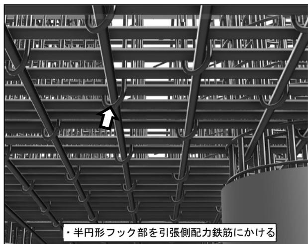
図-8. 前趾下面の配筋状況 (フーチング)
