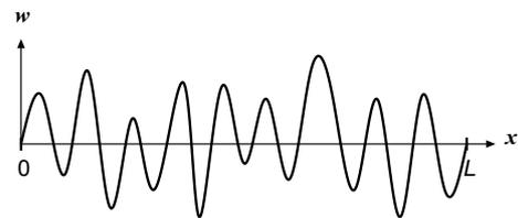
図-2 離散通り変位波形
