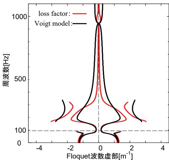
図-5 減衰モデルの違いが分散曲線に及ぼす影響 (Floquet波数虚部-周波数平面における無減衰系の分散曲線)
