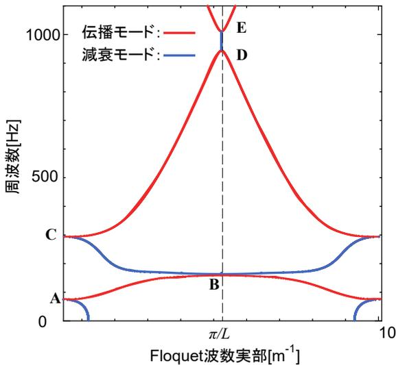
図-2 Floquet 波数実部-周波数平面における無減衰系の分散曲線
