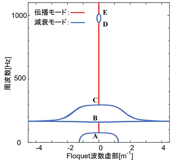
図-3 Floquet 波数虚部-周波数平面における無減衰系の分散曲線
