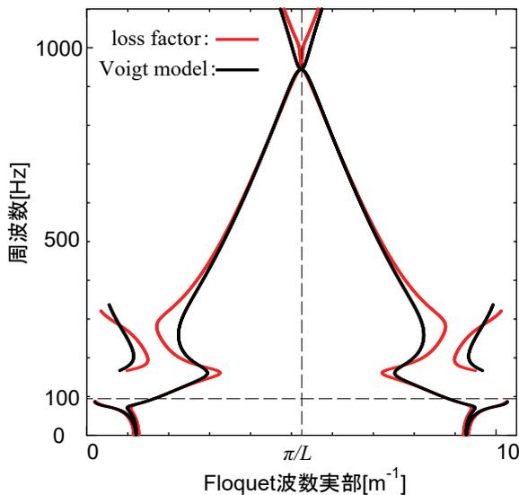
図-4 減衰モデルの違いが分散曲線に及ぼす影響 (Floquet波数実部-周波数平面における無減衰系の分散曲線)
