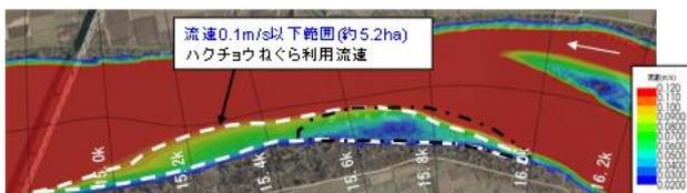
図-8 越冬期9割流量時(542m<sup>3</sup>/s)の流速
