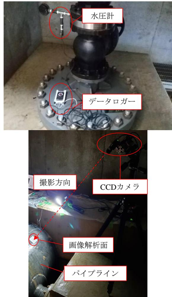
図-1 水圧計測（上）および DICM（下）
