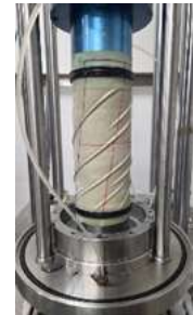
図-2 中空試験機（せん断後）
