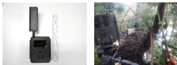
写真-2 使用したセンサーカメラと設置状況
